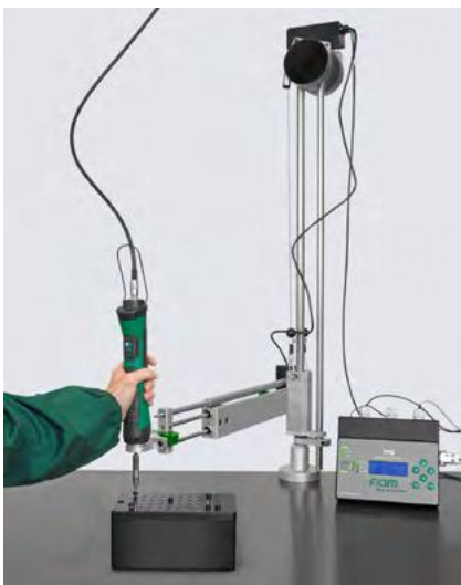
Braccio Cartesiano con dispositivo di rilevazione della posizione
